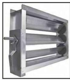
Клапаны воздушные изготавливаются с условным типоразмером ширины от 150 до 2000 мм и высоты от 100 до 2000 мм, с шагом 50 мм. При длине клапана не менее 1200 мм воздушный клапан изготавливается односекционным без перемычки. Управление клапаном осуществляется при помощи ручного регулятора (ручка входит в комплект поставки).
