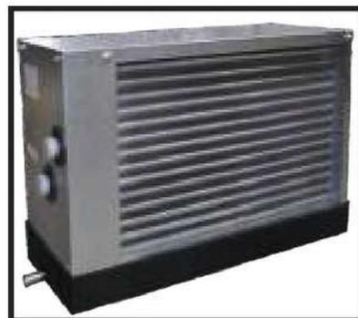
При двухступенчатом охлаждении у первого охладителя целесообразно каплеуловитель исключить (заказать охладитель без каплеуловителя). Водяные охладители в самом высоком месте коллекторов оснащены автоматическим продувочным вентилем. Он обеспечивает постоянное обезвоздушивание охладителя.
