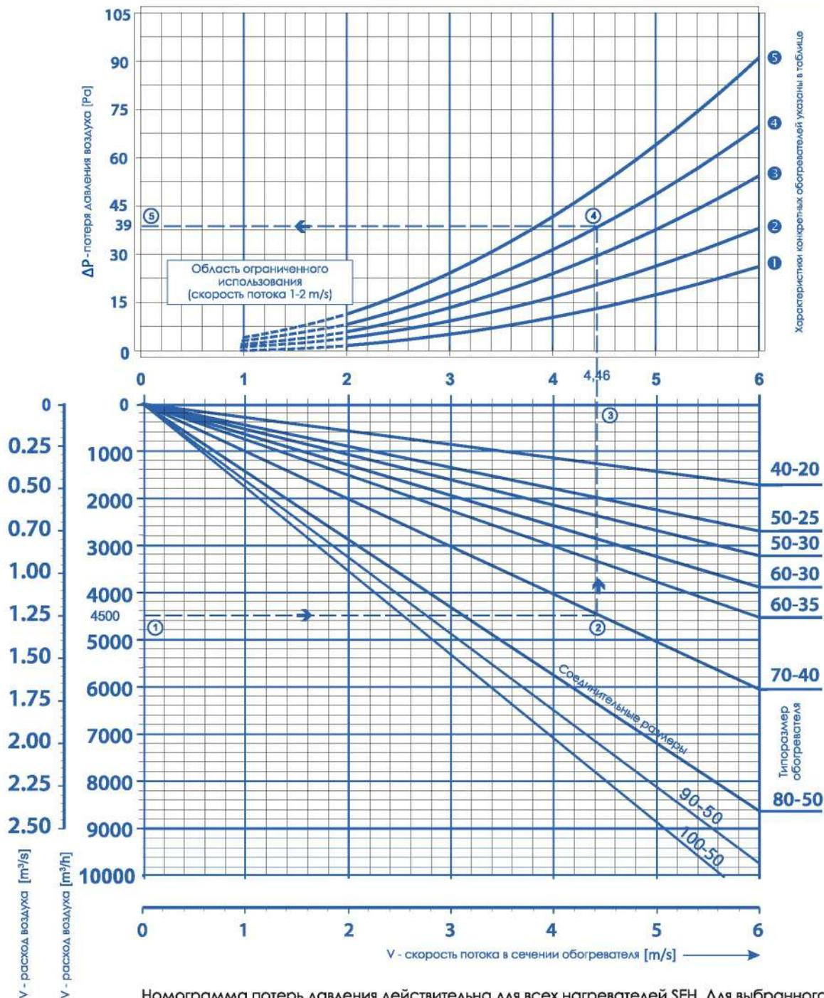
Номограмма потерь давления действительна для всех нагревателей SEH. Для выбранного расхода ① можно по нижнему графику определить скорость потока ③ в сечении нагревателя ②, а в последствии для известной скорости можно в верхней части ④ установить соответствующую потерю давления воздуха ⑤.
