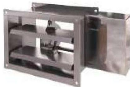
Канальный клапан LVD присоединяется/встраивается в воздуховод в системах противодымной вентиляции и может иметь как внутреннее, так и внешнее расположение привода. Номинальные размеры А и В стенового клапана представляют собой размеры проема в ограждении, в который вставляется клапан. Размеры тракта клапана меньше номинальных на 50 мм. Номинальные размеры А и В канального клапана определяют размер его тракта по внутренним плоскостям стенок его корпуса.
