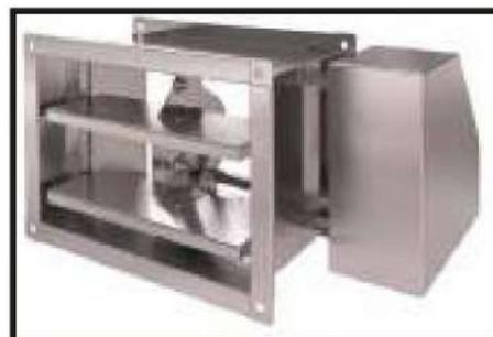
НЗ клапан в нормальных условиях имеет закрытый пакет заслонок и препятствует проникновению потока по тракту вентиляции в месте установки клапана. В условиях пожара, по сигналу управляющей противопожарной электросистемы, заслонки открываются и освобождают тракт вентиляции для выпуска потока из зоны пожара через клапан.
